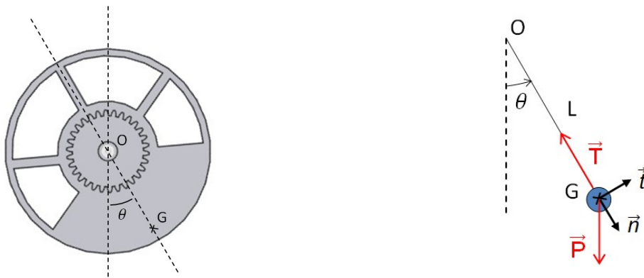
Figure 8 : modélisation de la roue pendulaire sous forme de pendule simple
